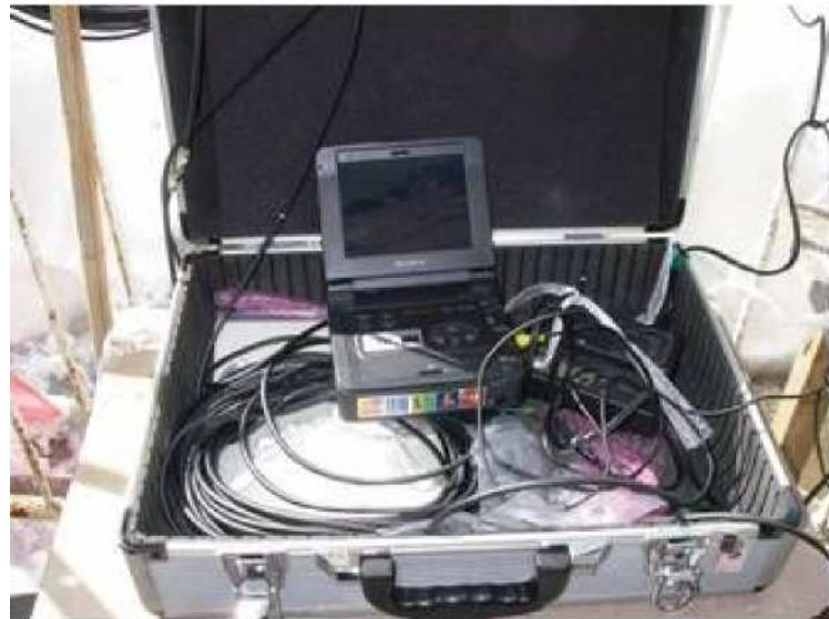
写真3 小型水中カメラのモニター
