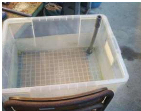
写真2 プラ製コンテナにオーバーフロー配管を加工して取り付け（ガラス水槽加工はこれを目指しました）
